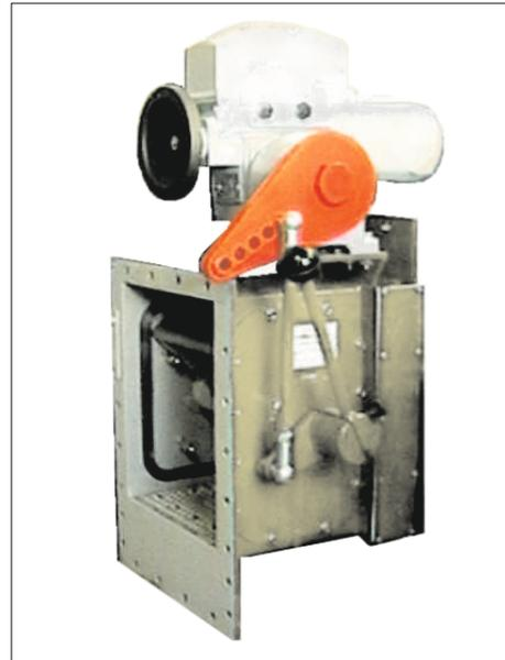
**FAB-Dosierwalze mit elektromotorischem Stellantrieb**
