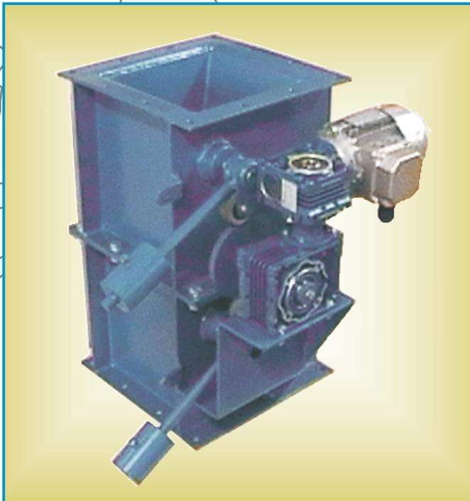
**FAB**-Pendelklappen und Doppelpendelklappen zum Absperrn und Dosieren. Bewährt für den täglichen Einsatz in Schüttgutanlagen. Antrieb mittels Getriebemotor, mit Pneumatikzylinder oder Gewichtsbelastet. Standardgrößen sowie alle Sondermaße lieferbar.
