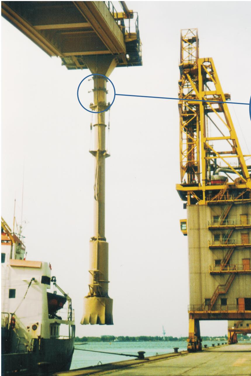
**FAB**-Doppelpendelklappe, gewichtsbelastet, eingebaut im Einlauf einer Verladeanlage für Getreide. Die Doppelpendelklappe läßt nur das ankommende Schüttgut durchfließen. Der freie Querschnitt des Einlaufes wird auf den für das Schüttgut erforderliche Maß begrenzt. Dadurch entsteht kein Sog des durchfließenden Schüttgutes, wobei kaum zusätzliche Falschluff angesogen wird.
